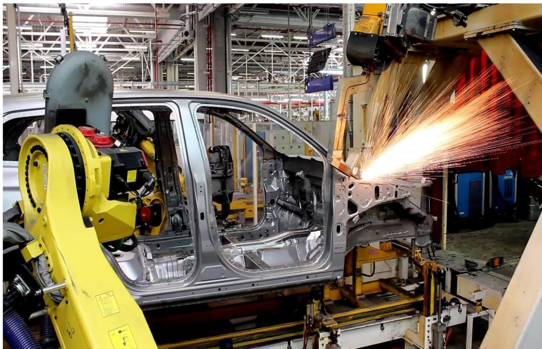
Рисунок 11 – Процесс сварки автомобильного кузова
